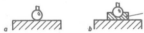
Bild 9 Die große Flächenpressung an einer Kugel-Ebene-Paarung (a) kann vermieden werden durch ein Zwischenteil 1, ohne die Zahl der Freiheiten der Paarung (hier 5) einzuschränken.
